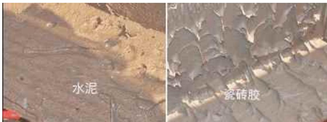
瓷砖胶是伴随现代化、多样化和工业化的瓷砖产品而诞生的，是解决现代材料（基材和瓷砖）、现代建筑形式和瓷砖施工复杂性的配套工业化产品。现场拌合砂浆则是上一时代的简单材料，是单一建筑与简单粘贴施工的基础辅助材料。
