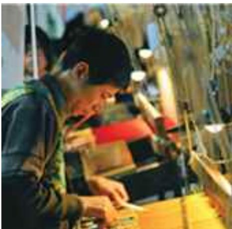
南京云锦工艺独特，用老式的提花木机织造，机身长5.6米，宽1.4米，高4米，必须由提花工和织造工两人配合完成，日产仅有5厘米，故有“寸锦寸金”之古喻，这种工艺至今仍无法用机器替代。云锦主要制作工艺是逐花异色，通经断纬，挖花盘织。这种织造方法的优点是：一根纬线，通过多次挖花完成，配色自由，不受色种限制，相同的单位纹样，可织成不相重复的色彩，使整件产品典丽和谐。时至今日，云锦仍然采用大型传统大花楼织机手工织造，这种独特的手工艺织造技艺仍无法用现代化机器替代。
