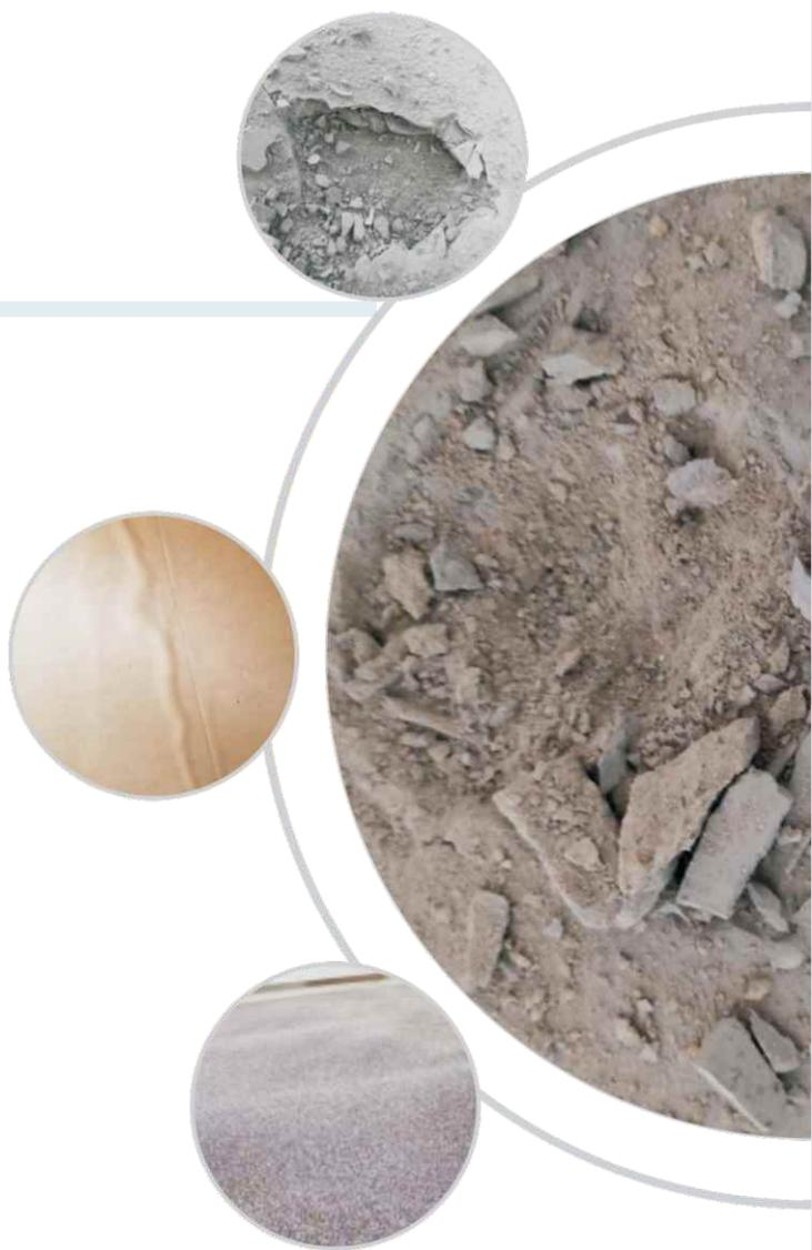
混凝土密封固化剂是混凝土密封硬化剂是一种无色透明液体材料，又名混凝土硬化剂或混凝土固化剂，是一种活性的无色透明化学水性制剂，由无机物、化学活性物质和络合物组成，可使混凝土表面的吸附性降低，防尘以及坚硬耐磨。其工作原理是与混凝土中大量的半水化水泥，游离石灰，钙发生化学反应（持续反应时间约为60-90天），形成一种永久性凝胶，该凝胶可在处理过的混凝土内部结晶成坚硬耐磨组织。从而得到一个无尘、致密的整体。如果作为起砂加固材料，则存在以下隐患：
